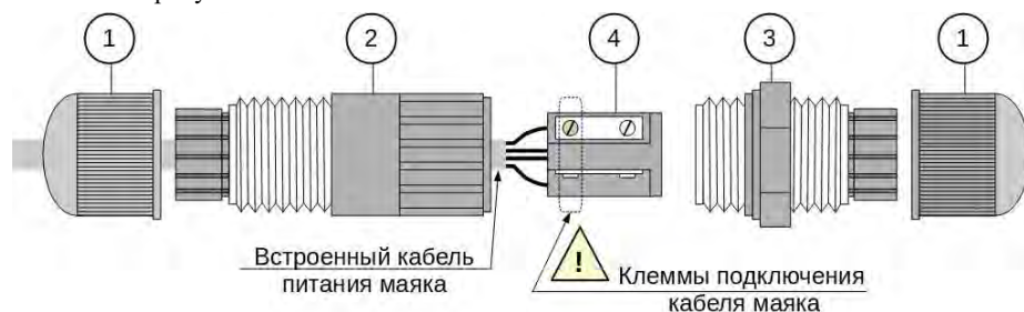
Рисунок 5 – Разъединение ответных частей корпуса разъема кабеля маяка
